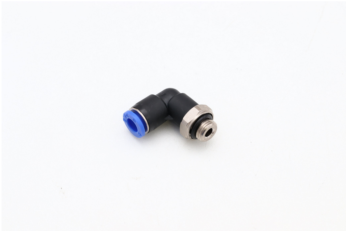
Winkelsteckverschraubung 1/8" für 6mm Ø zylindrisch, drucklos einstellbar mit O-Ring-Abdichtung
