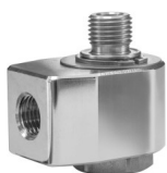
Winkeldrehgelenk 1/4"IG:1/4"AG MOS max: 150 BAR - 90°C 30U/min
