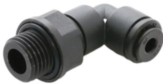
WINKEL-EINSCHRAUBVEBINDER für PL3 Schlauch PA6 DREHBAR 4 MM X G1/4" AG ( SPEEDFIT )
