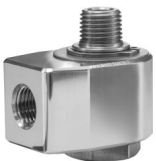
Winkel-Drehgelenk easywash 365+ 1/4"IG : 1/4"AG 275 bar Messing vernickelt
