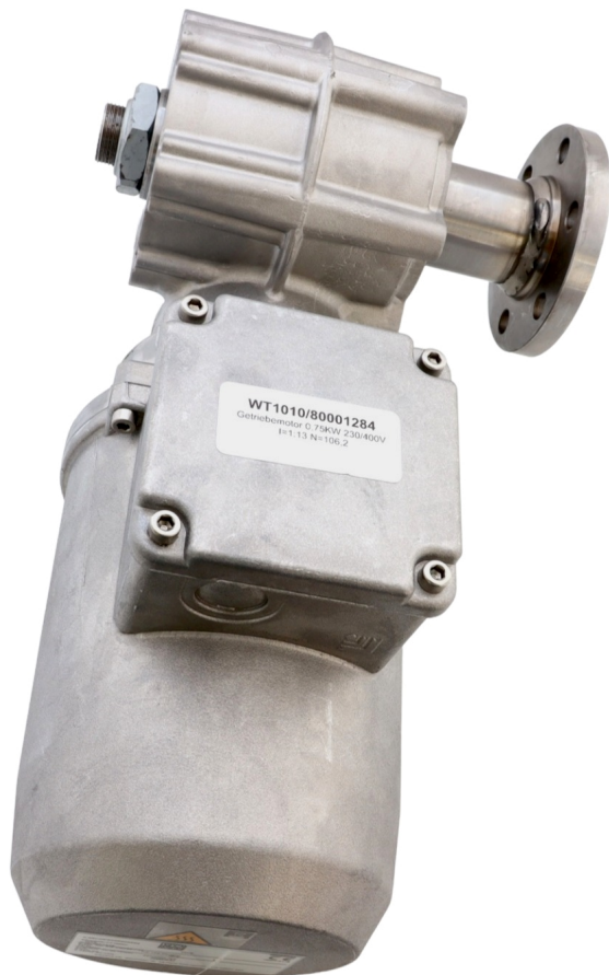
WALZENANTRIEB VMG DB SOFTECS-WALZE 13:1 0,75KW 106,7 UPM
