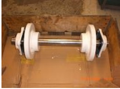
Umlenkswelle kompl. D50 VMG fürWash Tec Förderband Typ 6-0189 285mm Spurbreite
