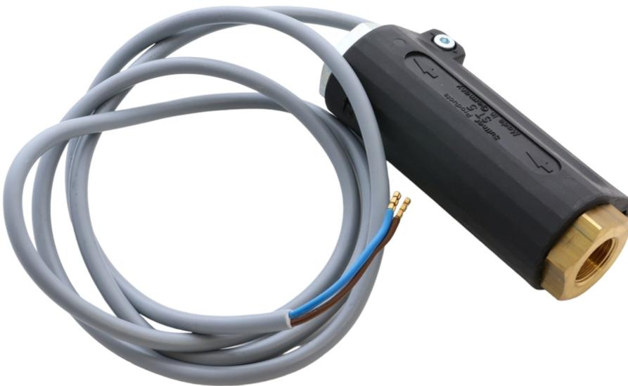
Strömungswächter 250V IG/IG 3/8" Druck 350 bar Durchfluss 30 lmin 0,3 l ein. 0,17 l aus max 80 C Einbau senkrecht mit 1,20m Kabel
