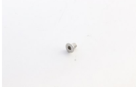
Senkschraube M6X10 A2-70 ISO 10642
