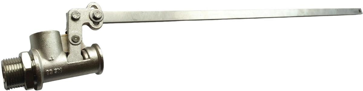
Schwimmerventil 1" aus Preßmessing Ms58 vernickelt mit Gewindeanschluss, Dichtung EPDM OHNE Schwimmer
