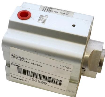
Kurzhubzylinder SB-Schrägstellung EC 2000 und CK45 RD50 Hub 40 für M8 Gummipuffer
