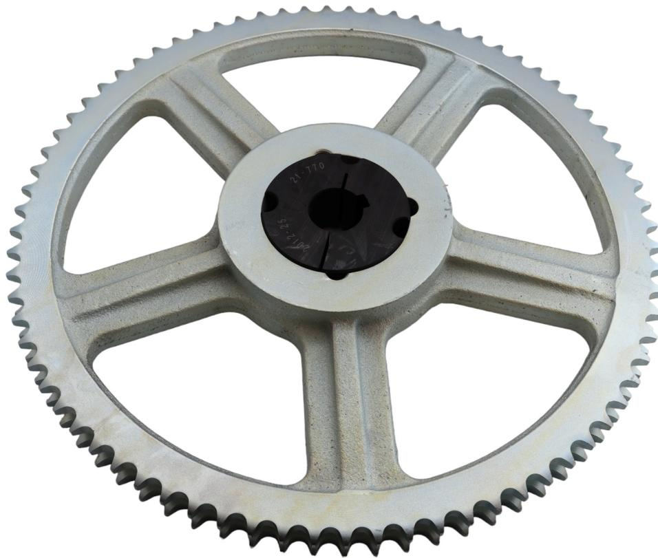
KETTENRAD DUPL. 1/2"X5/16" Z=76 mit Taberlockbuchse 2012 25 H7 UND KEILN.DIN
