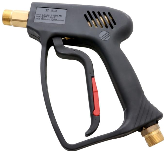
HD-Pistole Geschlossen ST-1500 Eingang: M22x1,5 AG / Ausgang: M22x1,5 AG Max. 275 bar / 45 l/min / 150°C z.b. Passend für Kärcher
