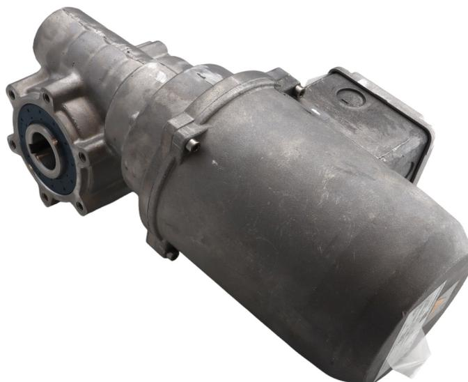
Getriebemotor Fahrtrieb ES Seite 0,25KW I=52:1 N=27,3 für Anlagen mit 0,75KW Frequenzumrichter
