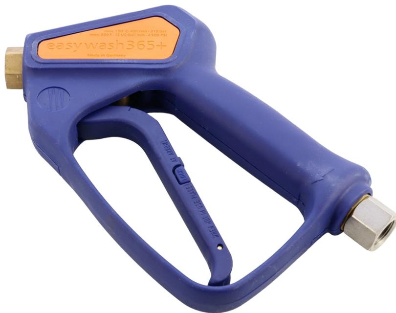
Easy Wash HD-Pistole Griff Blau Eingang: 3/8" IG drehbar/AG 1/4" Max. 310 bar / 45 l/min / 150 °C mit Frostschutz öffnen bei 3 Bar
