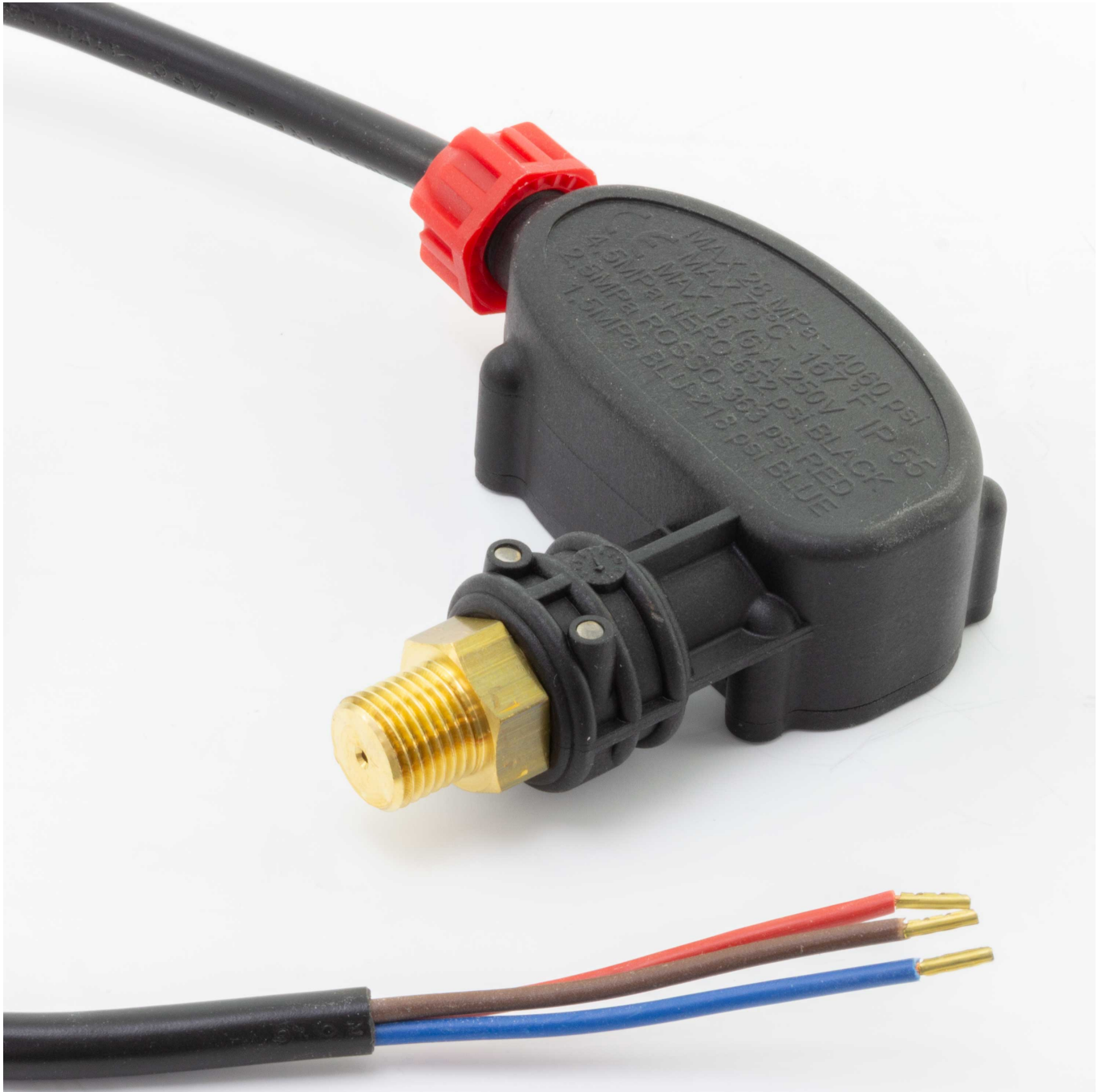
Druckschalter PR16 1/4"AG 15-350 Bar (blau) Kontakt 6 A - 250 V Kabel 1200 mm Max.350 bar / 75°C
